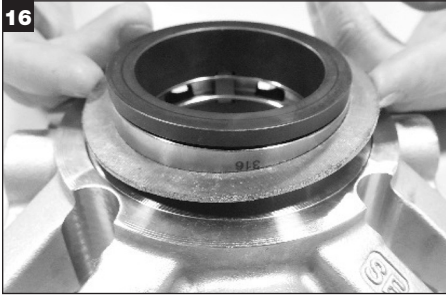
Contayı adaptörden çıkarın ve atın.
